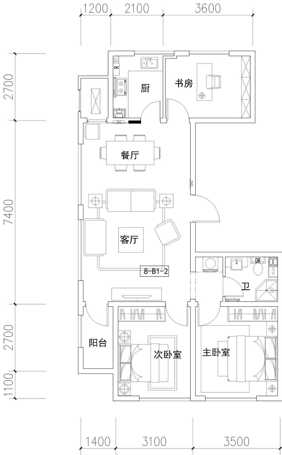
注：本图标注尺寸为 E3 代表性户型的图纸尺寸，因所在楼座、单元或楼层不同，尺寸会有差别，最终以房管部门测绘数据为准。
